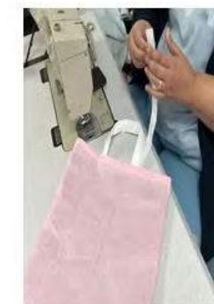
Colocação das alças
